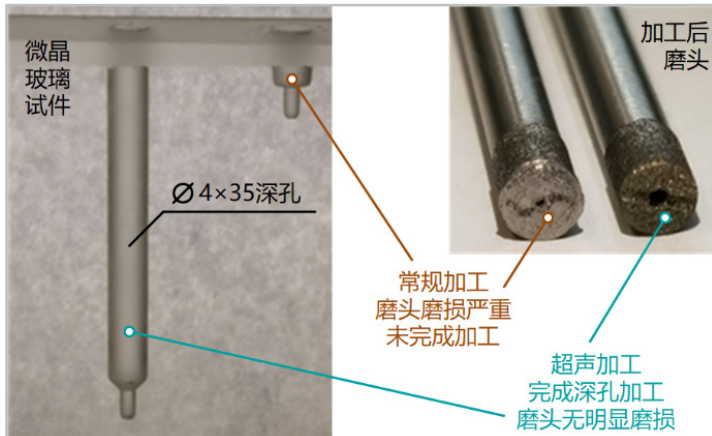
微晶玻璃深孔超声加工
